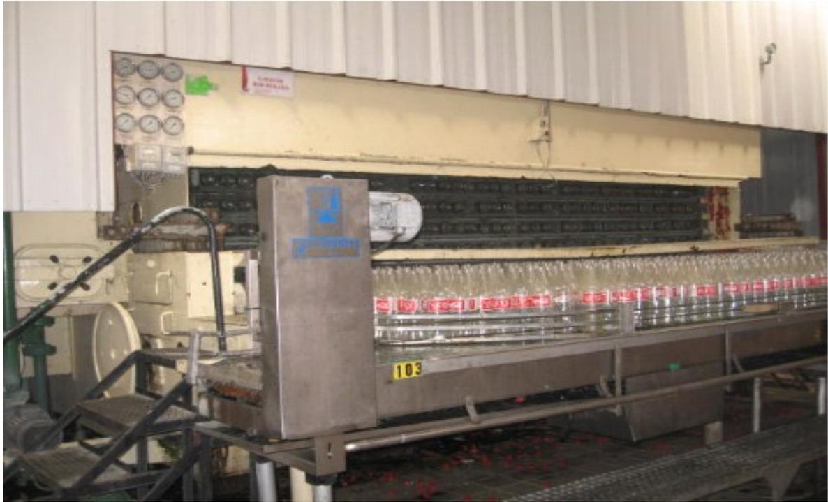
*Figure3 : Laveuse des bouteilles Inspectrice*
