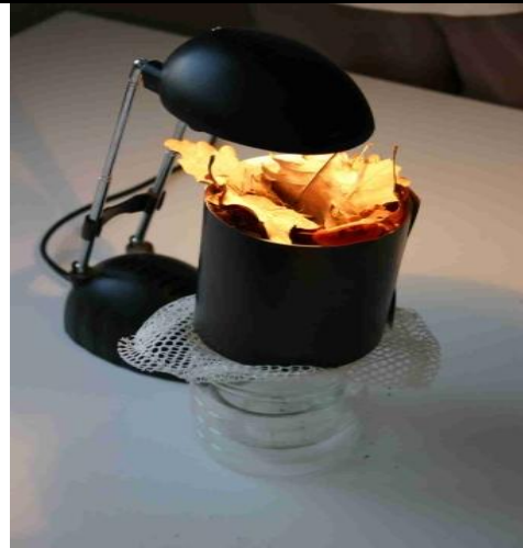
8: Placer une lampe au dessus de l'entonnoir et l'allumer (la lumière et la chaleur font fuir les animaux qui tombent dans le pot contenant de l'alcool).
