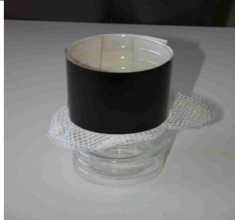
6 : L'appareil de Berlèse est prêt à l'emploi.
